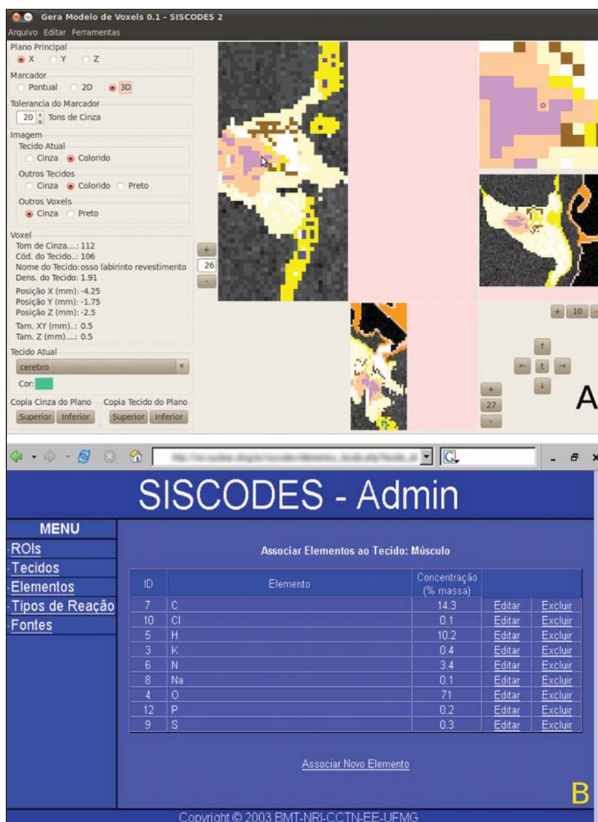
Figura 3. A: Interface do módulo de construção do modelo de voxels de tecidos mostrando a construção do modelo de voxels da região da orelha. B: Interface Web do módulo administrativo mostrando a página na qual é possível a edição da composição química dos tecidos e materiais.
